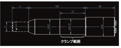
クランプ範囲とクランプ径は全てのバリエーションで同じです。つまり、MÖLLER-WEDEL OPTICAL 社にてコリメーターを異なる焦点距離に変更した後でも、ユーザーは今までのメカニカルマウントをそのまま使用できます。
