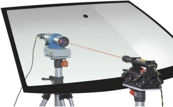
ECE R43 規格に準拠した、フロントガラスの二重像間の角度を測定するための装置です。目に安全なレーザー光源（レーザー安全クラス 2）、検査用望遠鏡、評価用ソフトウェアで構成されています。光学配置により、測定値は光源、フロントガラス、検査用望遠鏡間の距離に影響されません。
